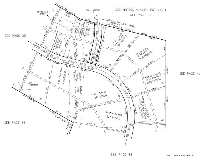
ALL UTILITY EASEMENTS ARE 10 FEET WIDE. THE DRAINAGE EASEMENT IS 100 FEET WIDE.
